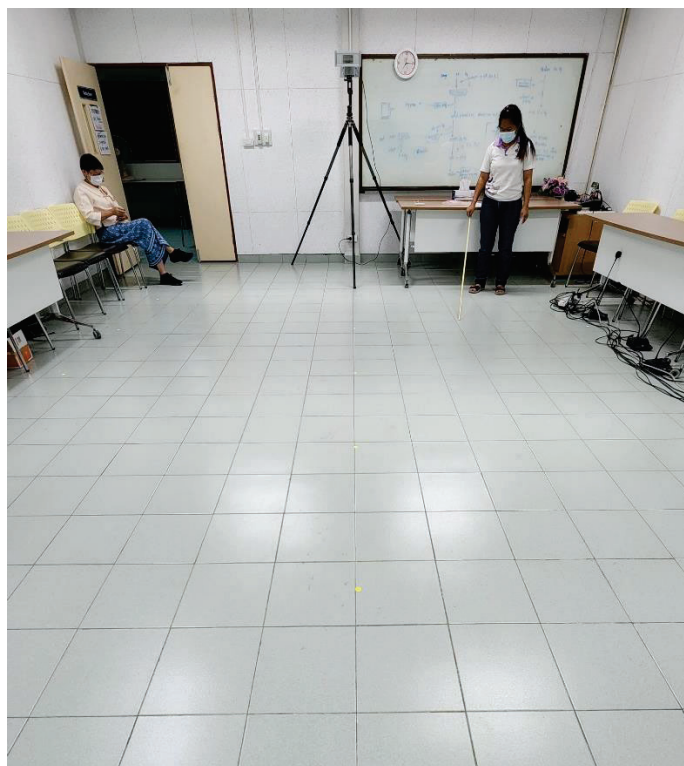
รูปที่ 6 การทดสอบการวัดปริมาณรังสี UVC คลื่น 222 นาโนเมตรในห้องขนาด 8.1 \times 5.8 เมตร
